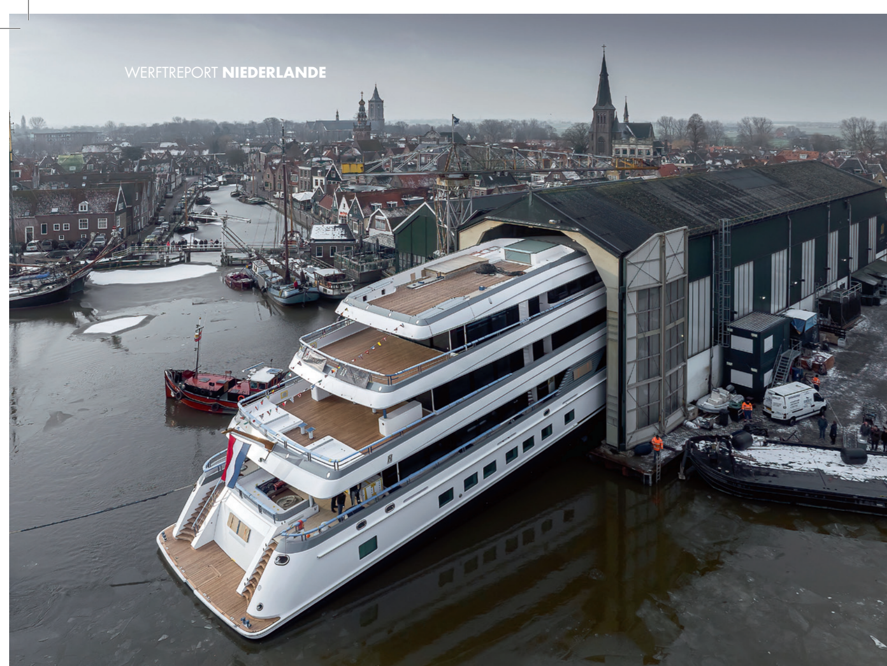
Zentimeterarbeit: Wenn Royal Hakvoort 61 Meter in Monnickendam ausdockt, wird es eng. Derzeit baut der Familienbetrieb 65 Meter, größer geht nicht.
